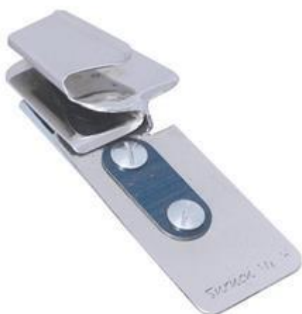
S705 zwijacz do łączenia, zszywania gorsetów do ramieniówki. CORSET ATTACHMENT
