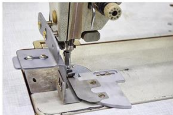
N605A przyrząd do szycia zakładki do stębnówki. LOCKSTITCH MACHINE RIBS ATTACHMENT
